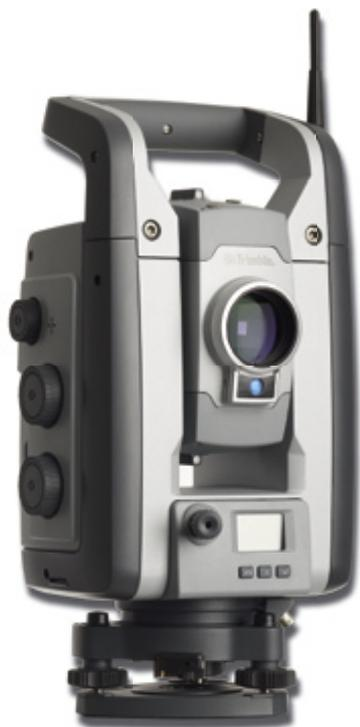
La estación total Trimble® S8 es la estación total más avanzada de Trimble. Diseñada para lograr un rendimiento inigualable en aplicaciones topográficas y especializadas, la Trimble S8 ofrece una precisión angular de 1" y una precisión MED de 1 mm + 1 ppm, además de varias características para mejorar la eficiencia y productividad.
